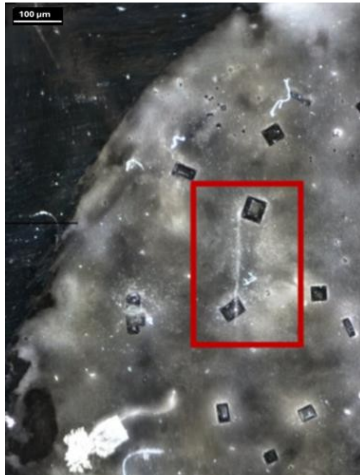
Figura 102. Imagen de baja magnificación del borde de la gota después de dos meses, destacando la transición de las estructuras cristalinas desde formaciones iniciales blandas a arquitecturas más grandes y organizadas. La región marcada indica la posición de un "Ensamblaje Cristal-Fibra" (CFA), como se detalla en la Figura 92, ofreciendo una referencia para hipotetizar mecanismos de organización estructural dentro de la matriz. Ampliación 25x.
